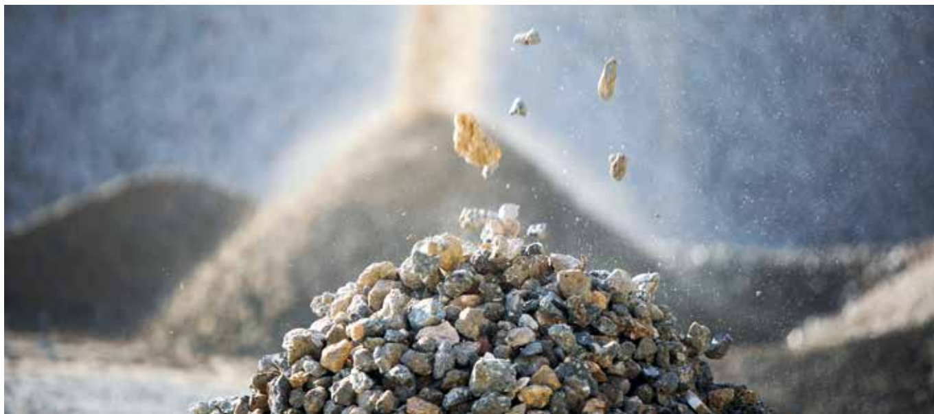
Das Recycling Center Himberg macht Kreislaufwirtschaft möglich. Diese Recyclinganlage stellt Recyclingbaustoffe aus mineralischen Baurestmassen her – insbesondere aus Asphalt, Beton, Bauschutt und natürlichen Gesteinen.
